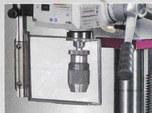
• Protección del portabrocas de grandes dimensiones y ajustable en altura, con desconexión automática al abrir el protector. Todo ello pensado para la mayor protección del usuario.
