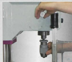
• Cambio sencillo de herramientas mediante dispositivo de extracción rápida (B28 H).
