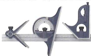
**Con transportador de ángulos, plataforma de ángulos y cabezal central en la regla corredera. Transportador con doble reborde.**
