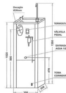
Instalación mediante tres puntos de conexión básicos
