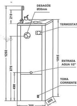
Instalación mediante tres puntos de conexión básicos.
