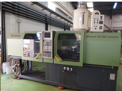
Inyectora termoplastico 50 ton.
