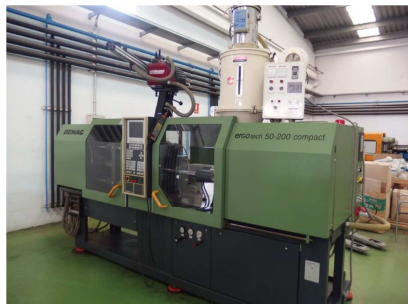
Inyectora termoplastico 50 ton, con robot coladas.
