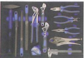
Contiene alicate pico de loro de 250 mm, alicate universal de 250 mm, alicate corte oblicuo de 250 mm, alicate boca redonda con corte de 250 mm, 3 limas de 250 mm, tenaza Grip de 150 mm, pie de rey de 150 mm, llave ajustable de 150 mm y 200 mm, flexómetro de 5m y martillo de 500g.
