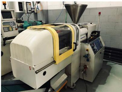
**Inyectora termoplástico 35
