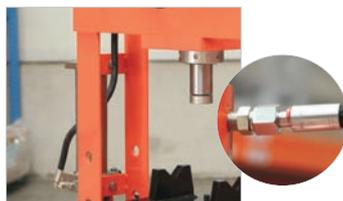
· Las mangueras hidráulicas y las unidades de conexión cumplen con la norma DIN 20066.
