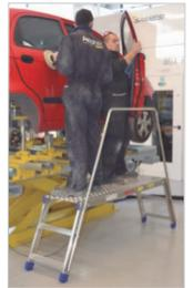
**ANDAMIO CON PLATAFORMA.** En aluminio. Con **tubo redondo de Ø 50 mm**, base plegable. Mediante los distintos módulos, puede aumentar la altura de trabajo hasta max de 6,66 m, sin anclaje a la pared. Carga máx. de 200 kg. **SMART 625 con 2 plataformas de trabajo incluidas.**
