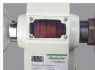
Con cristal de seguridad para controlar la velocidad escogida de la correa trapezoidal. Fácil colocación de la correa mediante la palanca tensora.
